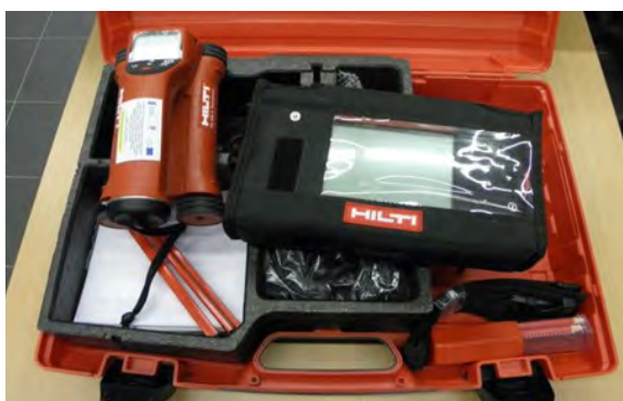
System lokalizacji i detekcji PS 200 System Ferroskan
