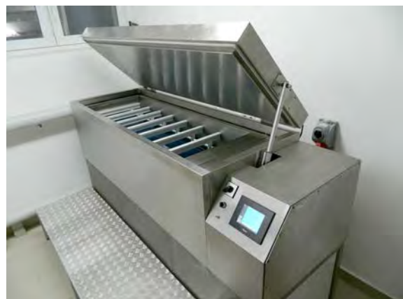
Komora klimatyczna do badania mrozoodporności metodą CDF
