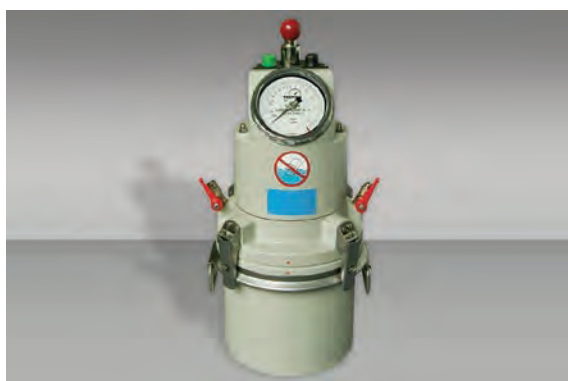
Aparat do badania zawartości powietrza metodą ciśnieniową PN-EN 12350-7
