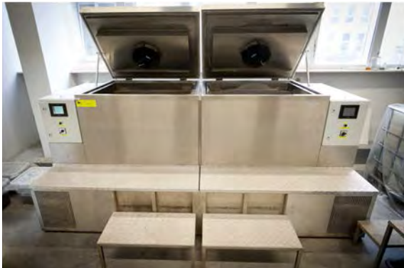
Komora klimatyczna do badania mrozoodporności
