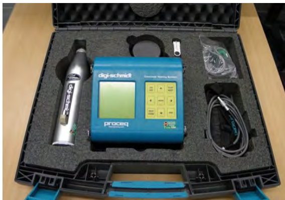
Młotek Schmidta typu N z rejestratorem firmy Proceq Szwajcaria
