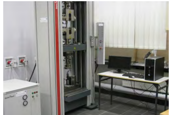
Elektromechaniczna maszyna wytrzymałościowa (Zwick) \pm 250 kN
