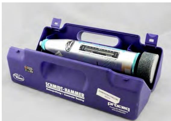
Aparatura do badań nieniszczących – młotek Schmidta
