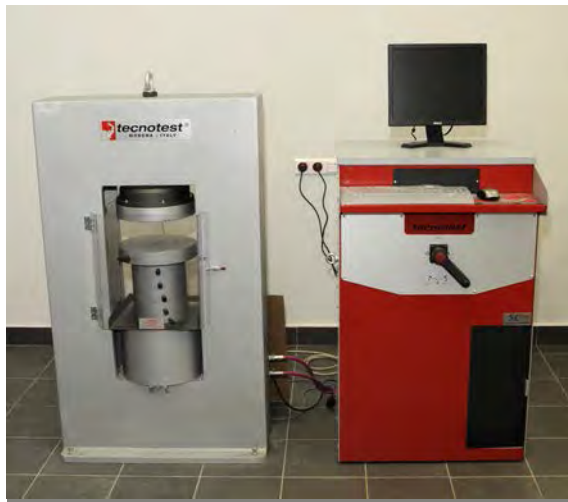
Prasa wytrzymałościowa do 3000 kN (dwuzakresowa)
