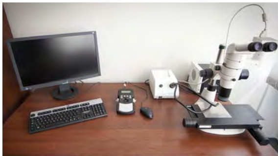
Zestaw do oznaczenia charakterystyki porów powietrznych w stwardniałym betonie wg PN-EN 480-11
