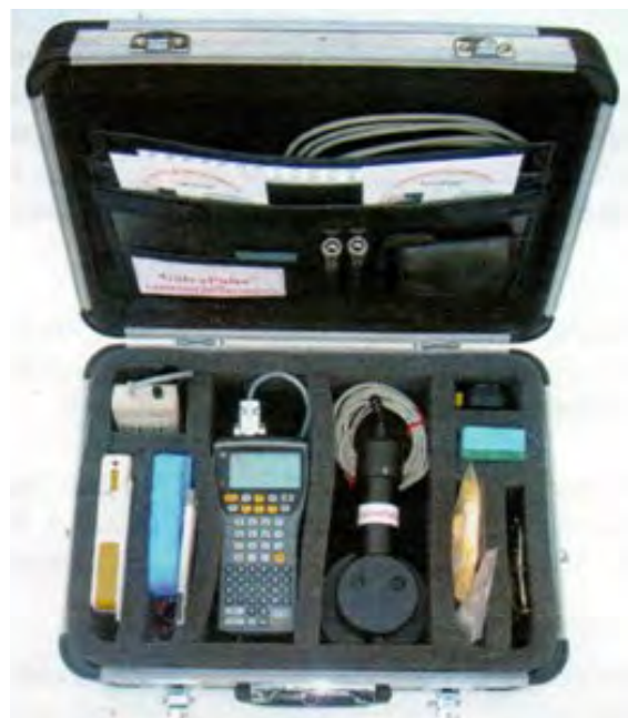
Zestaw pomiarowy GalvaPulse™ GP-5000 do oceny zagrożenia korozją stali zbrojeniowej w betonie
