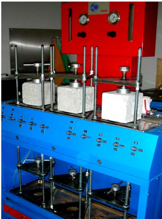
17. Urządzenie do pomiaru wodoprzepuszczalności betonu wg PN-EN 12390-8.
