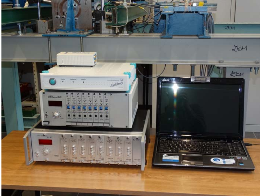
Rys. 1. Zestaw pomiarowy do analizy przemieszczeń i odkształceń modeli badawczych (mierniki przemieszczeń MPL – 108, MPL – 508 oraz system pomiarowy SPIDER 8)
