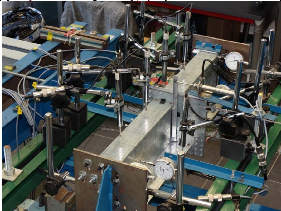
Rys. 4. Stanowisko do doświadczalnego wyznaczania lokalnej i dystorsyjnej nośności krytycznej oraz nośności granicznej prętowych elementów cienkościennych
