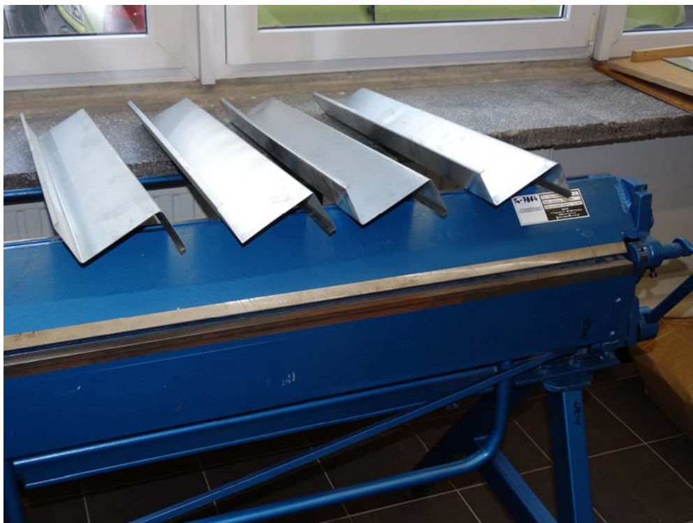
Rys. 3. Zaginarka ZG2000/1,2 do wyginania elementów cienkościennych.
