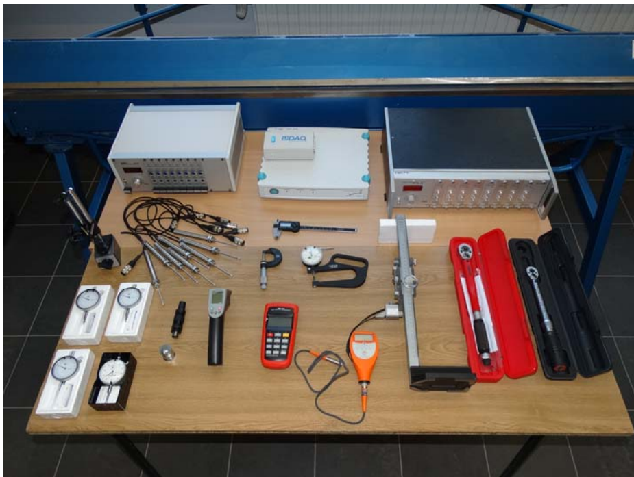
Rys. 2. Wybrane akcesoria (indukcyjne i zegarowe czujniki przemieszczeń, przyrządy do pomiaru geometrii i grubości ścianek elementów cienkościennych, imperfekcji geometrycznych, grubości powłok ochronnych itd.)
